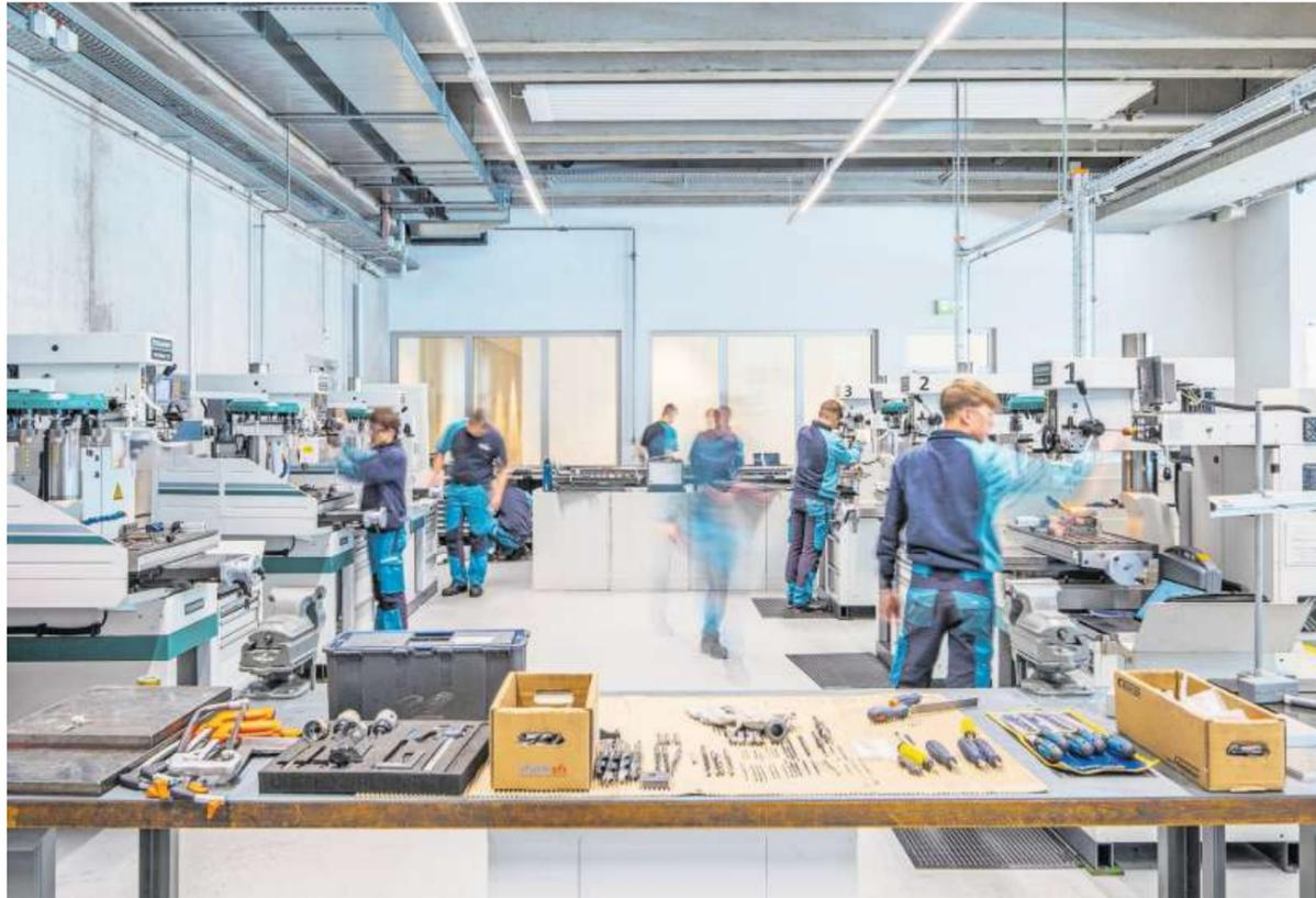
In der Lehrwerkstatt lernen Polymechnikerinnen und Polymechniker das Handwerk des Drehens, Fräsens, Bohrens und Montierens.
